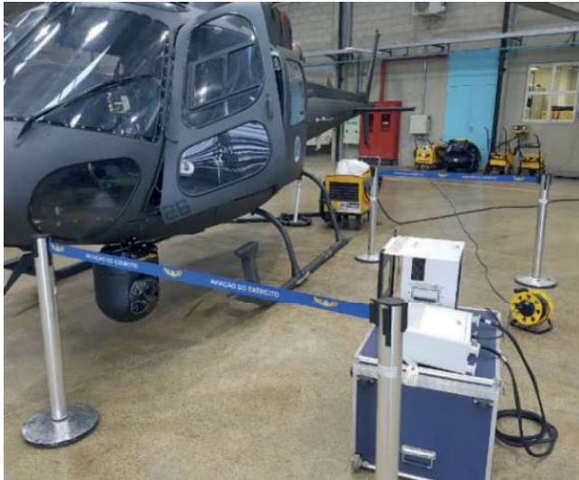
Figura 3 – Configuração montada para as medições. A foto apresenta um helicóptero com FLIR instalado visualizando um Corpo Negro.
