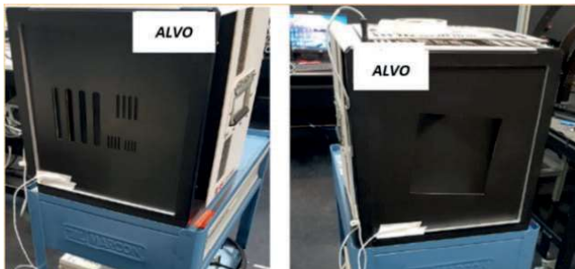
Figura 4 – Alvos utilizados para aquisição das imagens (padrão 4 Barras a esquerda e quadrado vazado a direita), com um termopar acoplado à base dos mesmos.
