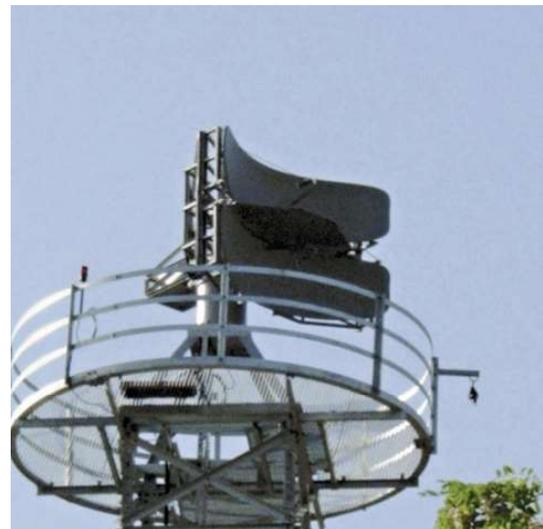
Figura 2 - Radar LPI de vigilância espanhol Aries, banda de operação de 600 MHz.
