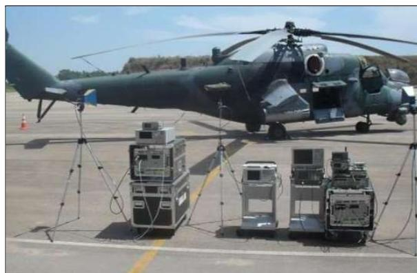
Fig. 15 – Atividade de campo dos alunos do PPGAO e do CEAAE, com instrumentos do LabGE para Avaliação Operacional do “Radar Warning Receiver” (RWR) da aeronave AH-2 [1]
