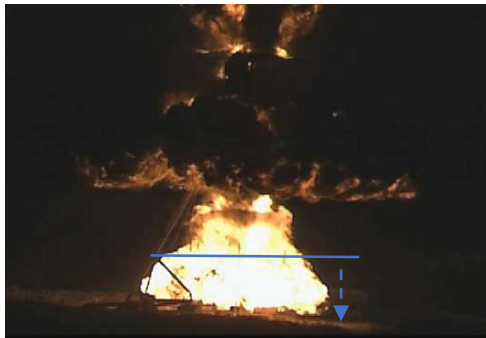
Fig. 7. Registro de frente de onda refletida se deslocando contra a laje 2 na sequência da imagem da Fig. 6. Imagem obtida a 3,3 ms do disparo da espoleta.
