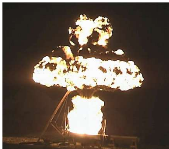
Fig. 5. Registro da frente de onda incidente contra a face superior da laje 2. Imagem obtida a 0,9 ms do disparo da espoleta.
