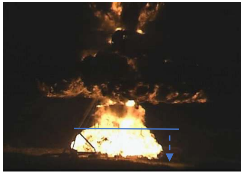
Fig. 6. Registro de frente de onda refletida se deslocando contra a laje 2. Imagem obtida a 3,2 ms do disparo da espoleta.
