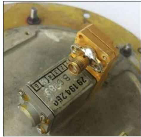
Fig. 4. Adaptação de conector SMA em antena do MAGE do P-95.
