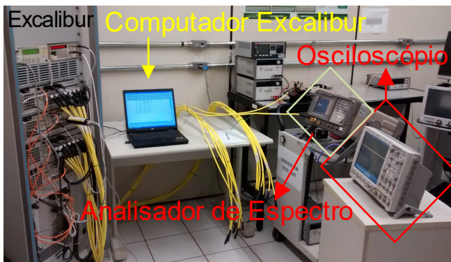
Fig. 06 – Caracterização dos sinais radar diretamente na saída de RF do Sistema de Geração de Ameaças Radar DRS-Excalibur.
