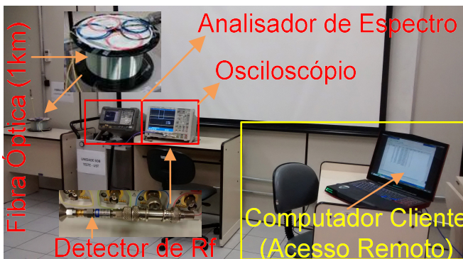
Fig. 12 – Foto do arranjo experimental remoto para avaliação dos sinais radar. A fibra óptica do enlace é de 1 km e conecta o simulador DRS-Excalibur aos equipamentos de medida na sala remota.
