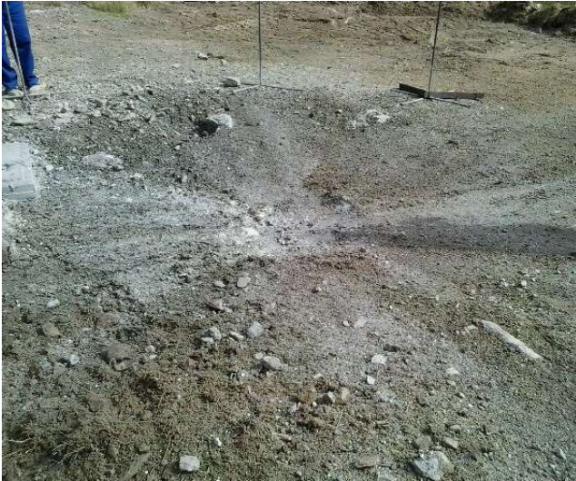
Fig. 3. Resultado da explosão do PBX posicionado sobre a laje de concreto.
