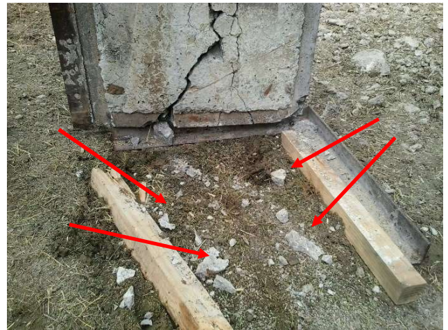
Fig. 6. Fragmentos que se desprenderam da placa de laje durante a ação da onda de choque na detonação a 1,5 m da laje. As setas indicam alguns dos fragmentos.
