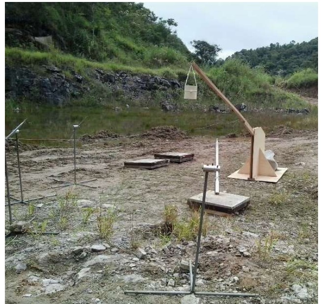
Fig. 2. Medidores de pressão posicionados em volta da carga explosiva. O braço de madeira suspenso a carga explosiva na altura determinada para o ensaio acima da placa de concreto.
