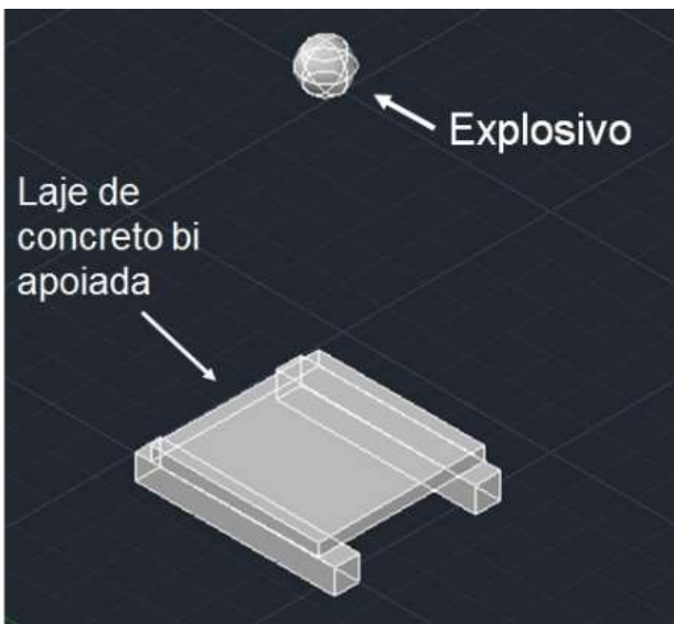
Fig. 1. Dispositivo para o ensaio experimental.
