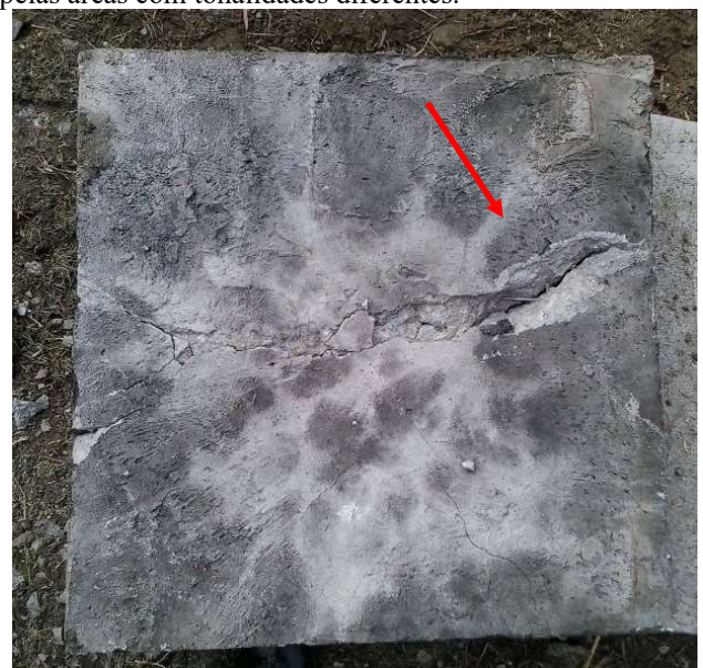
Fig 7. Face superior da laje onde é possível observar perda de material, indicado pela seta, devido ao encurvamento côncavo a que a laje é submetida durante a carga da onda de choque na detonação a 1,5 m.
