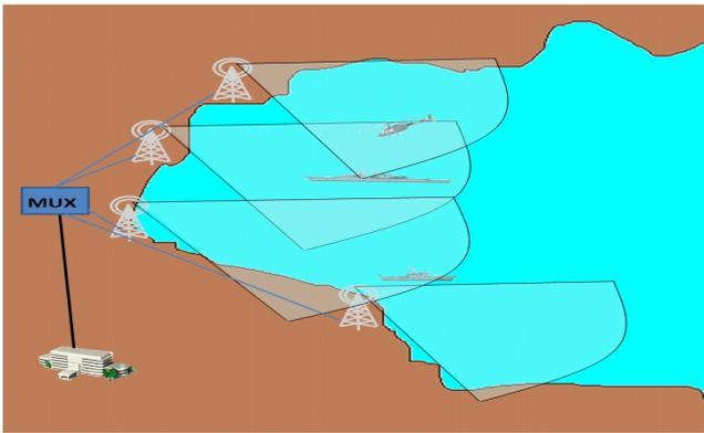
Fig. 1. Representação simplificada de uma possível raia de Avaliação Operacional de GE com o gerador de sinais de RF remotamente localizado (1 km) em relação aos conjuntos antenas/amplificadores [2].
