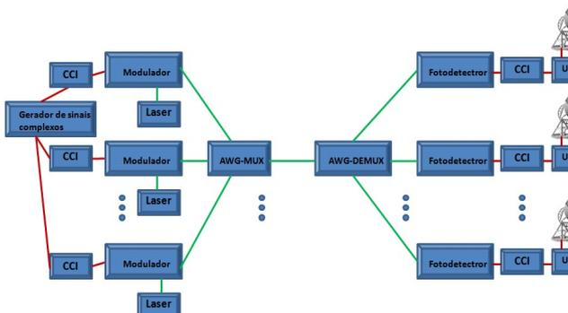
Fig. 2. Representação esquemática simplificada de um sistema de antena remota para uma raia de Avaliação Operacional de GE. A linha verde significa enlace na faixa óptica do espectro e a vermelha na faixa de RF. CCI - Circuito de Casamento de Impedância [2].
