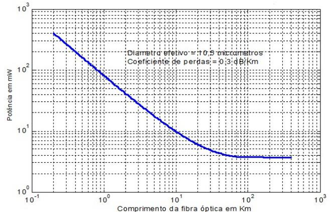
Fig. 6. Representação do limiar de potência em uma fibra óptica para evitar o fenômeno de espalhamento de Brillouin com uma fonte óptica CW [1].
