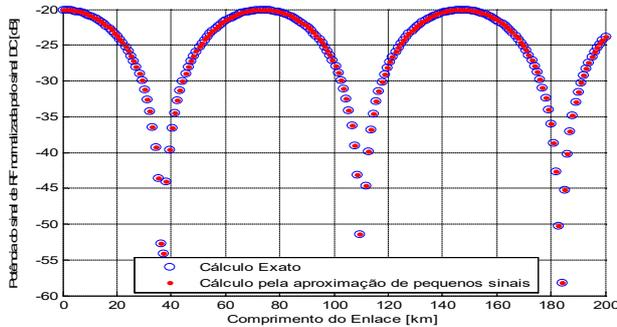
Fig. 7. Variação da potência normalizada detectada no fotodetector do sinal de RF (10 GHz) quando o índice de modulação,  $m_i=0,1$ .
