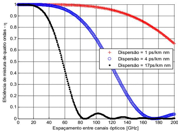
Fig. 5. Eficiência da mistura de quatro ondas em relação à separação de canais para fibras ópticas com dispersão diferente de zero deslocada (NZ-DSF), fibra óptica com dispersão igual à deslocada à zero (DSF) para 1550 nm e fibras monomodo padrão (SSMF).
