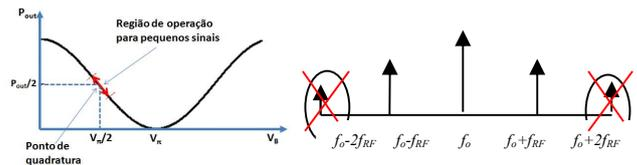
Fig. 3. Representação do comportamento da potência do sinal na saída do MZM. A esquerda, o comportamento no domínio do tempo. A direita, o comportamento no domínio da frequência.
