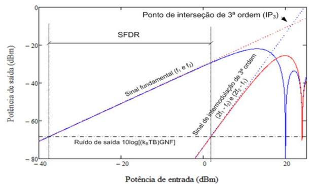
Fig. 4. Representação esquemática da SFDR para potência do sinal de RF na entrada do MZM em comparação com a potência de RF de terceiro harmônico [1].
