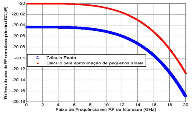
Fig. 9. Variação da potência normalizada detectada no fotodetector do sinal de RF em função da variação de frequência quando o índice de modulação,  $m_i=0,1$ .
