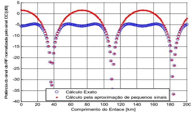
Fig. 8. Variação da potência normalizada detectada no fotodetector do sinal de RF (10 GHz) quando o índice de modulação,  $m_i=1,2$ .
